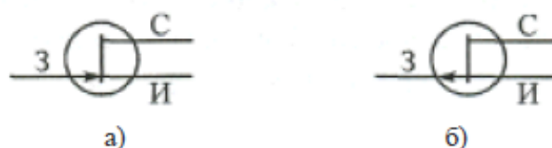
Рисунок 6. - Условное обозначение полевого транзистора:
